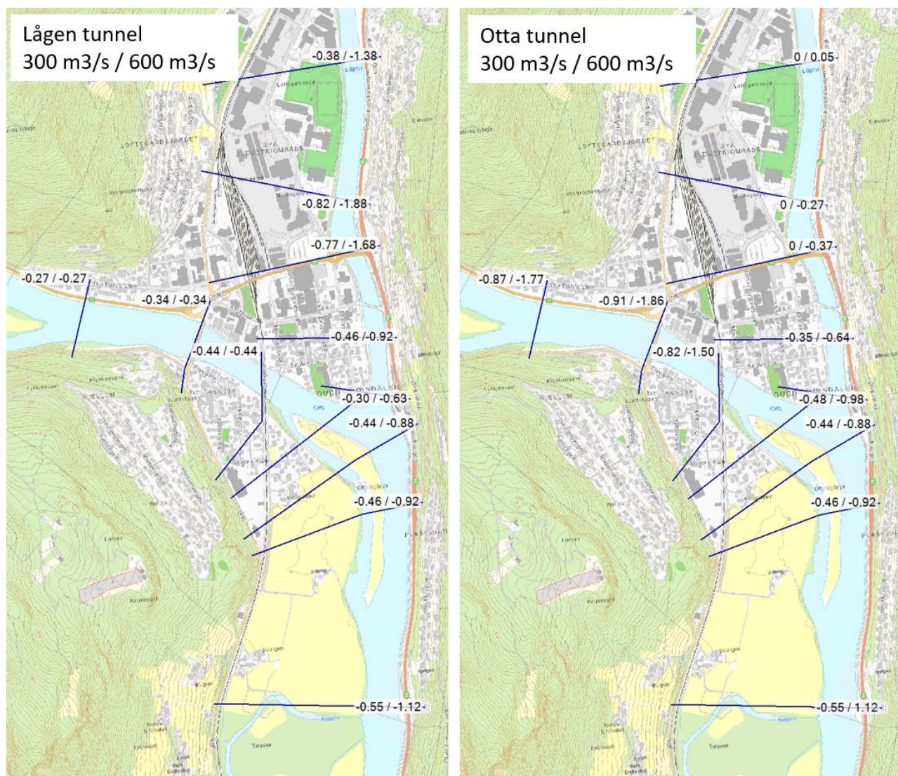
Figur 25 Reduksjon i vannstand ved Otta sentrum fra simulering med flomtunnel i hhv. Lågen (venstre figur) og Otta (høyre figur). Oppgitte verdier er vannstandsreduksjon i meter, sammenliknet med scenario uten tunnel. Verdiene er oppgitt for tunnelkapasitet 300 m 3 /s og 600 m 3 /s. Se også Tabell 4.
