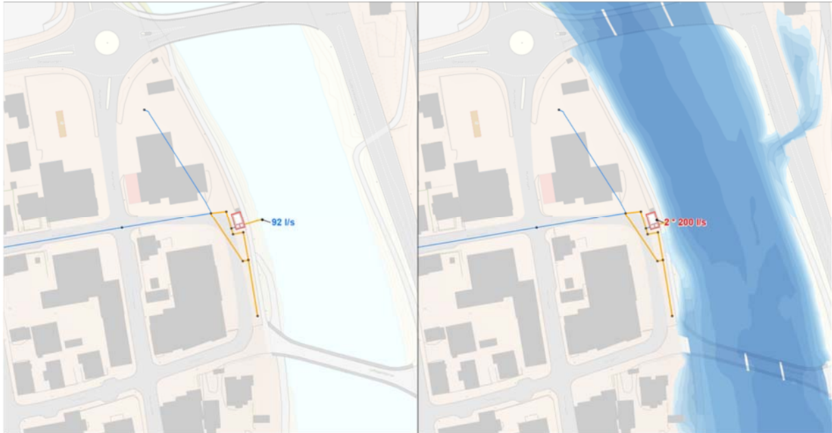
Figur 3.4: Avløpsnettberregning Q2 i planlagt tilstand for Nordmogata (til venstre: frie utløp, til høyre: tilbakestuvning Q200 med aktivt pumpeanlegg G6)
