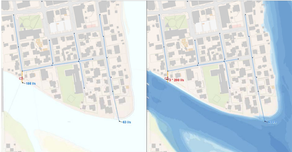
Figur 3.5: Avløpsnettberegning Q2 i planlagt tilstand for Otta sør (til venstre: frie utløp, til høyre: tilbakestuving Q200 med aktivt pumpeanlegg O4)
